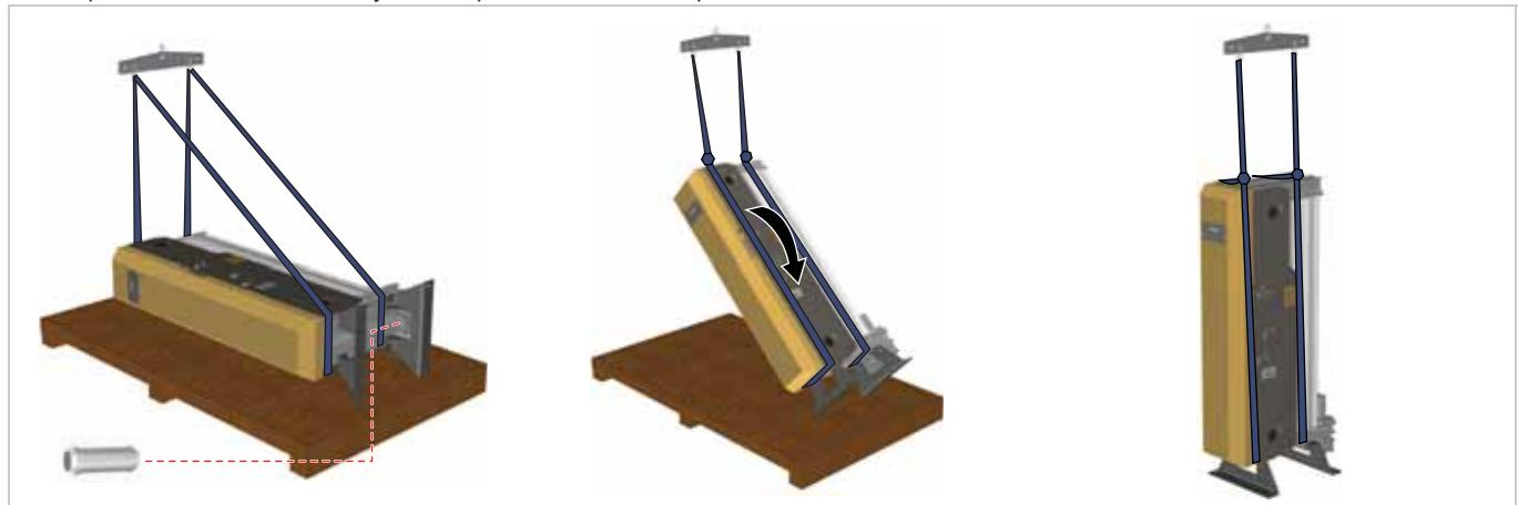
Снимите четыре деревянных бруска с задней стороны кожуха.
